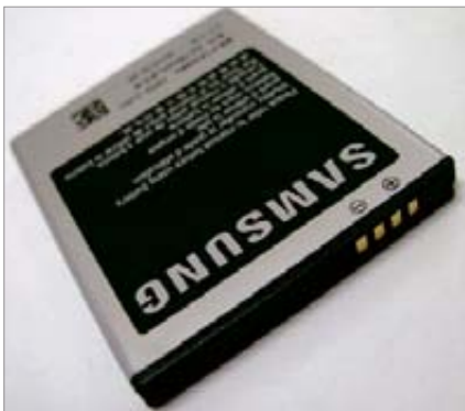
Las baterías actuales tienen sistemas de protección contra sobrecargas.
